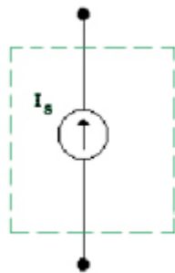
รูป 2.12 ก. แหล่งจ่ายไฟตรงกระแสคงที่ในอุดมคติ และ ข. แหล่งจ่ายไฟตามสภาพที่แท้จริง
