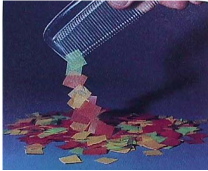
ภาพที่ 1-4 วิธีที่ผ่านการขั้วสามารถดูดกระดาษได้ เนื่องจากกระบวนการโพลาไรเซชัน
