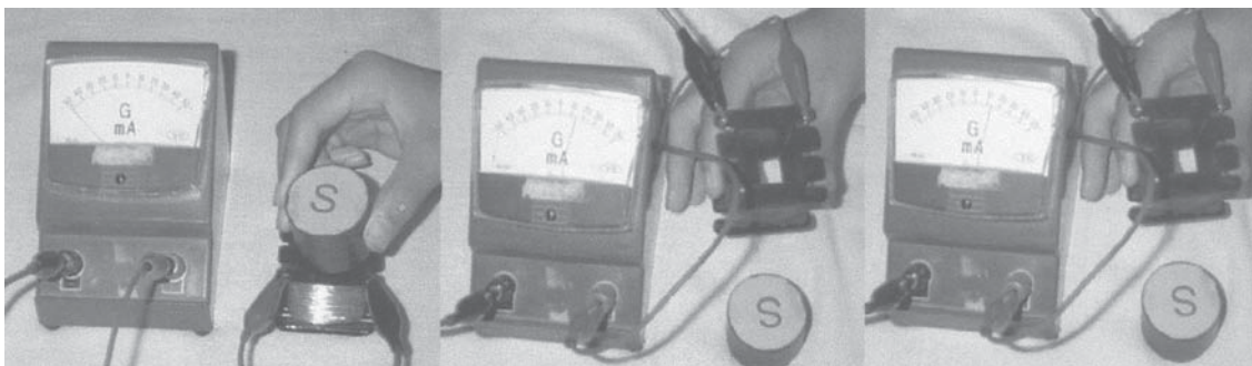
แสดงการเกิดกระแสเหนี่ยวนำโดยให้ขดลวดเคลื่อนที่
