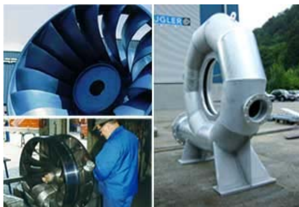
ภาพที่ 7.11 แสดงตัวอย่างกังหันน้ำฟรานซิส ที่มา (Hydro Energy, 2003. On-line)
