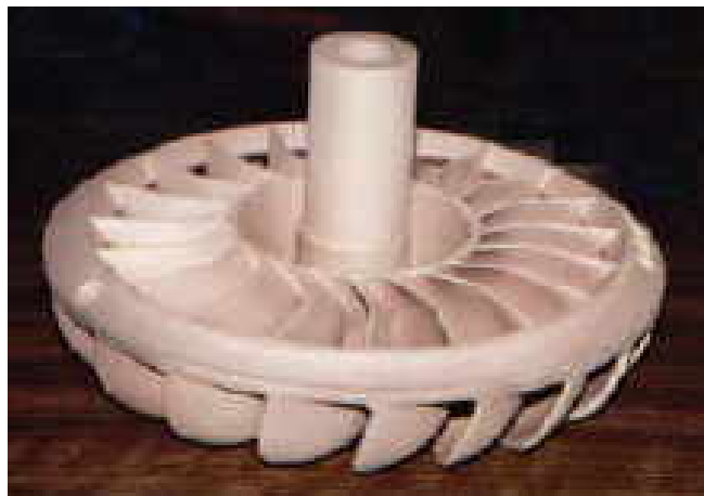
ภาพที่ 7.10 แสดงตัวอย่างกังหันน้ำเทอร์โก ที่มา (Kansas Wind Power. 2005. On-line)
