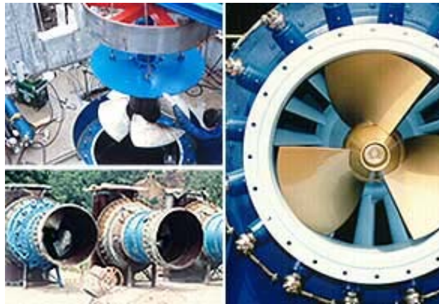
ภาพที่ 7.12 แสดงตัวอย่างกังหันน้ำเคปแลน ที่มา (Hydro Energy. 2003. On-line)
