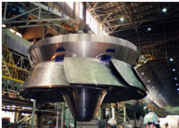
ภาพที่ 7.13 แสดงตัวอย่างกังหันน้ำเดริซ ที่มา (Mitsubishi Heavy Industries Ltd. 2003. On-line)
