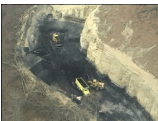
ภาพที่ 4.5 แสดงตัวอย่างการทำเหมืองเปิดตามแบบเครื่องเจาะ ที่มา (Kentucky, 2000. On-line)
