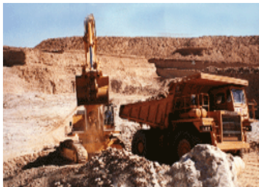
ภาพที่ 4.4 แสดงตัวอย่างการทำเหมืองเปิดแบบเปิดหน้าดินเฉพาะส่วน ที่มา (B&E International. 2005. On-line)
