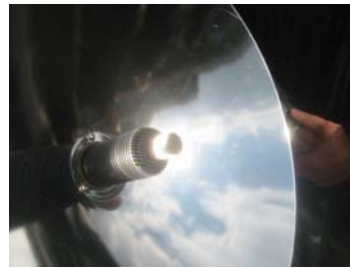
เครื่องยนต์สเตอร์ลิงที่ใช้พลังงานแสงอาทิตย์เป็นแหล่งพลังงานความร้อน
