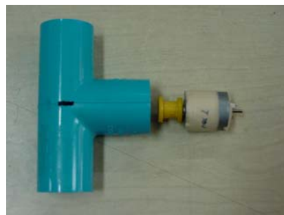
รูปที่ 8 ภาพการประกอบมอเตอร์เข้ากับท่อฟิวส์สามทาง
