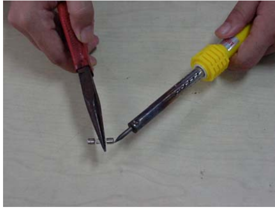
รูปที่ 6 ภาพการทำท่อแก้วจากการถอดขั้วฟิวส์ด้วยหัวแร้ง
