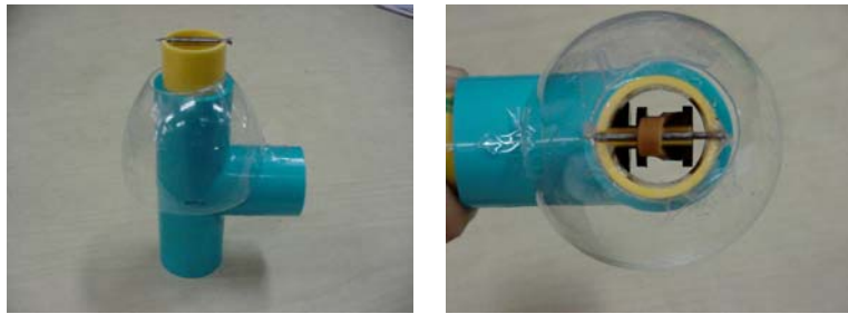
รูปที่ 9 ภาพการวางตะปูบนท่อพีวีซี(3)พร้อมกับแท่นรองกระป๋อง(ปากขวดน้ำ) และการร้อยเส้นยางเข้ากับแกนมอเตอร์และท่อแก้ว
