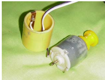
รูปที่ 7 ภาพการต่อสายไฟเข้ากับมอเตอร์และสวิตช์
