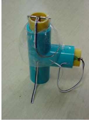
รูปที่ 10 ภาพการติดแทนร่องกระป๋อง สายไฟประจุบวกและสายไฟประจุลบ
