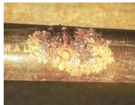
รูปที่ 2.6 ลักษณะการกัดกร่อนแบบ Pitting Corrosion
