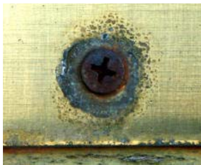
รูปที่ 2.4 ลักษณะการกัดกร่อนแบบ Galvanic Corrosion
