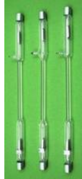
รูปหลอดบรรจุก๊าซขณะยังไม่เปล่งแสง
