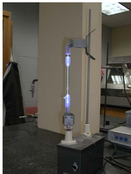
รูปหลอดบรรจุก๊าซขณะเปล่งแสงเมื่อต่อกับศักย์ไฟฟ้าสูง
